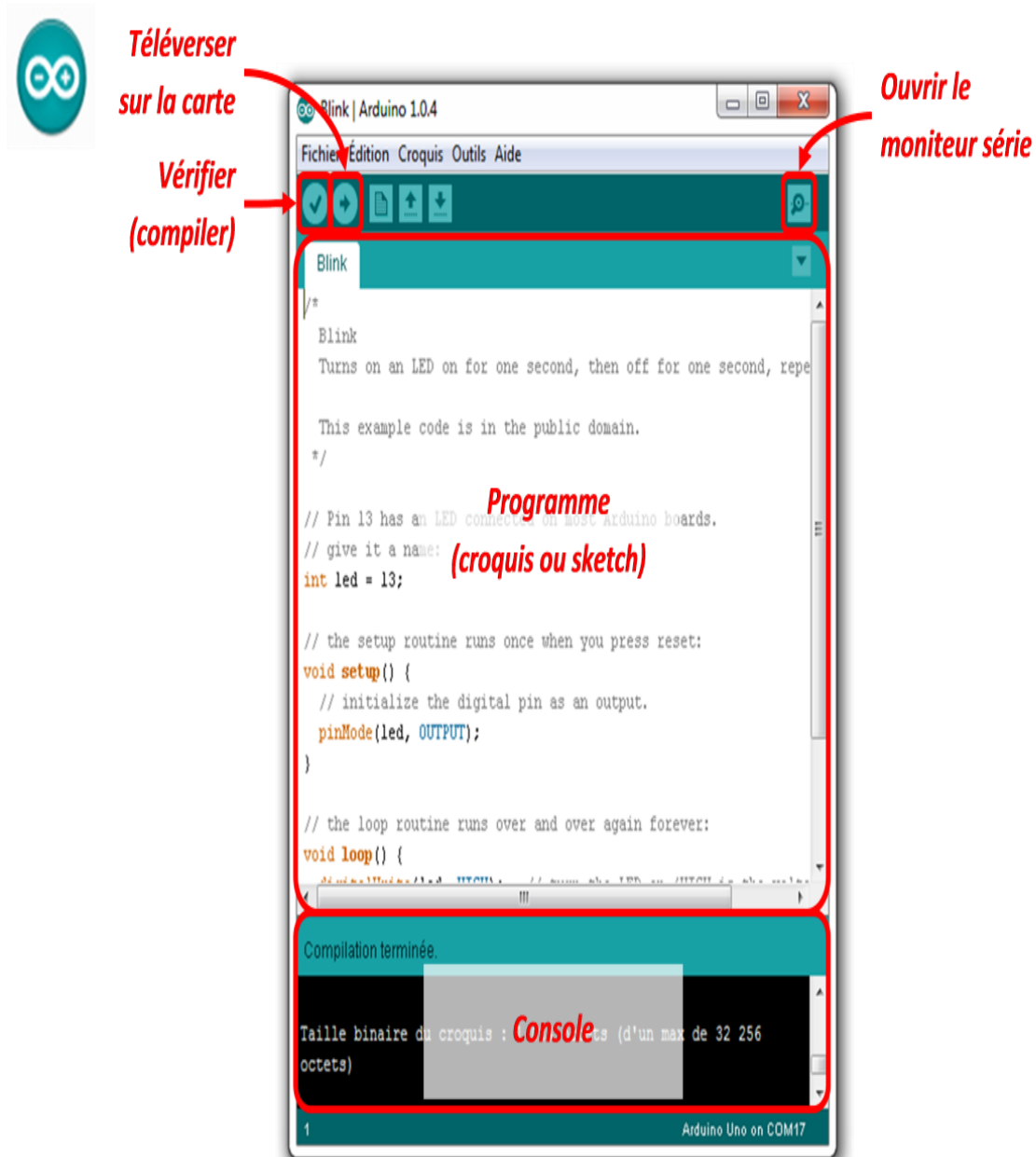
Figure III.10. Compilation et télé-versement du programme
