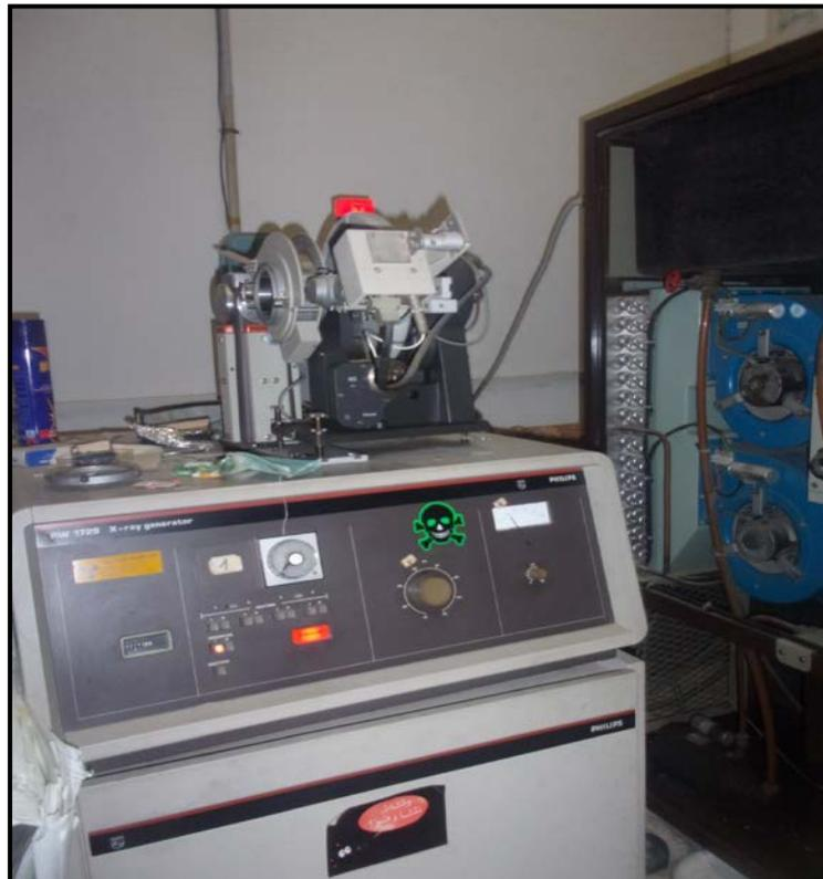
*Figure 17. L'appareil de mesure le diffractomètre modèle PW 1729.*
