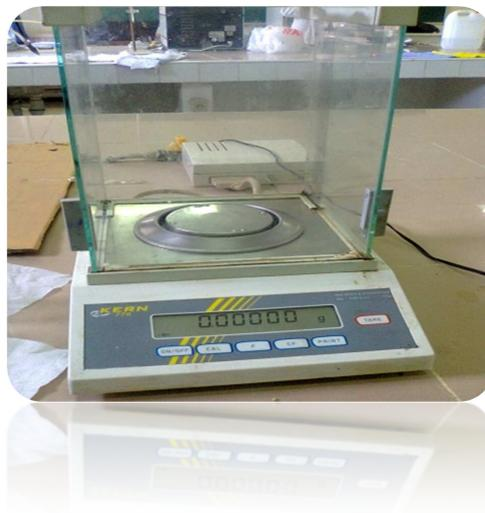
Figure 11: La balance de précision (photo originale).
