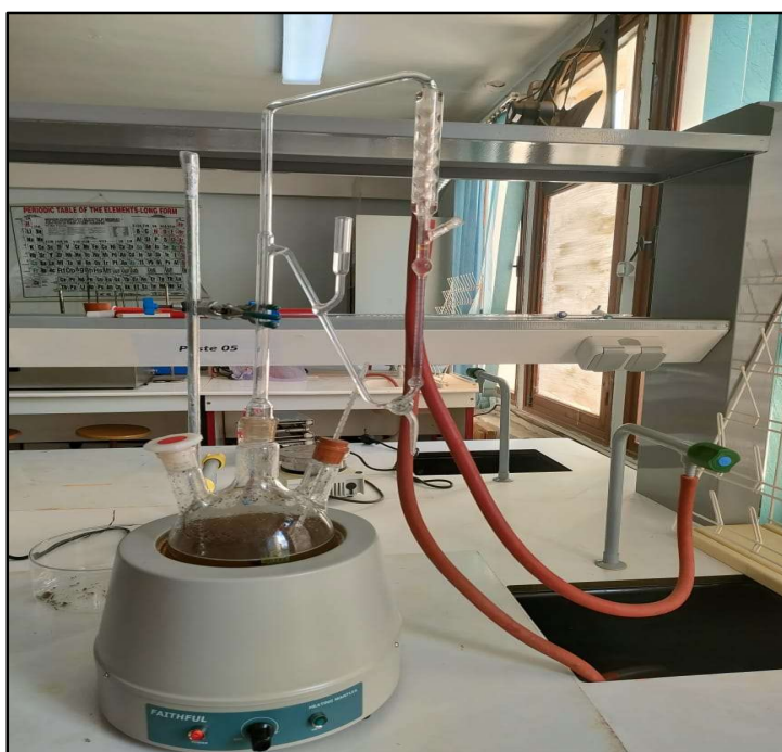
Figure 2.3 : Hydrodistillation de l'HE par un appareil de type : Clevenger.
