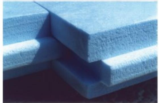
**Figure II-15.** Polystyrène extrudé en panneau. (Source : C. Langlais & al.)
