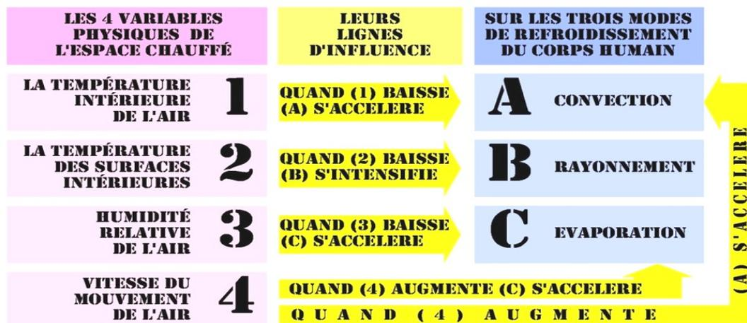
Figure II-7. Relations entre les paramètres de confort et les modes d'échange de chaleur<sup>72</sup>
