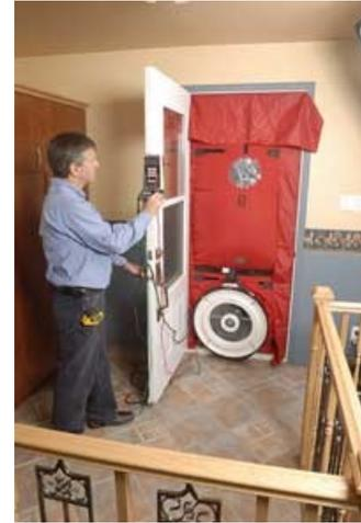
**Figure III-19.** Essai d'infiltrométrie.
