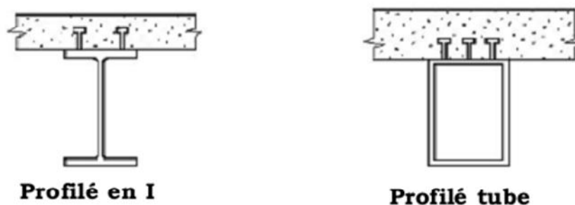
Fig. I-6 : exemples de type de profilé métallique
