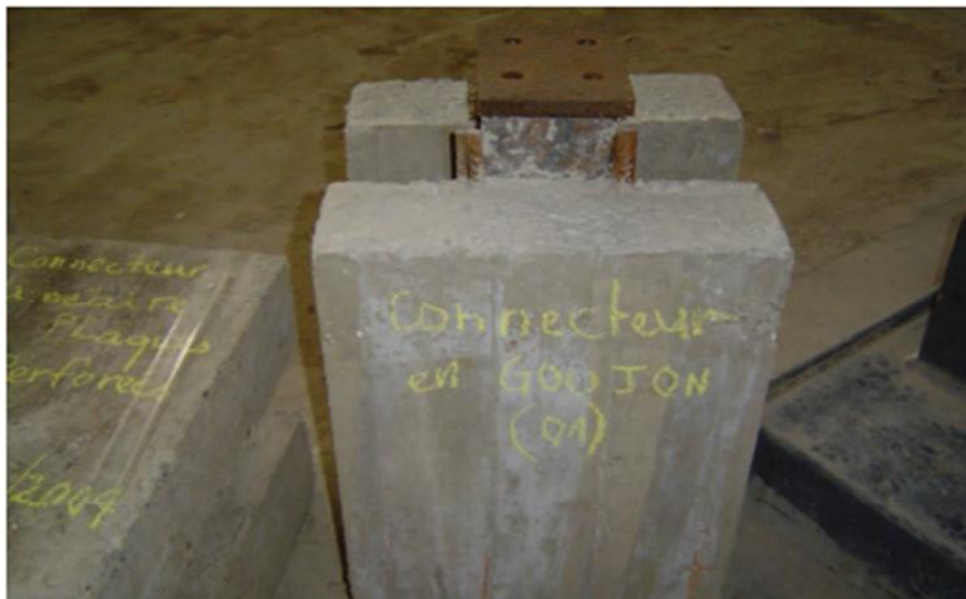
Fig. II-17 : Epreuve finalisée avec dalles de béton.
