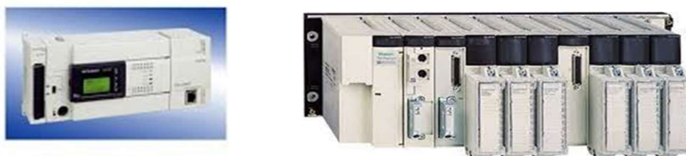
Figure III.1 : Exemple d'automate compact (gauche) et modulaire (droit).
