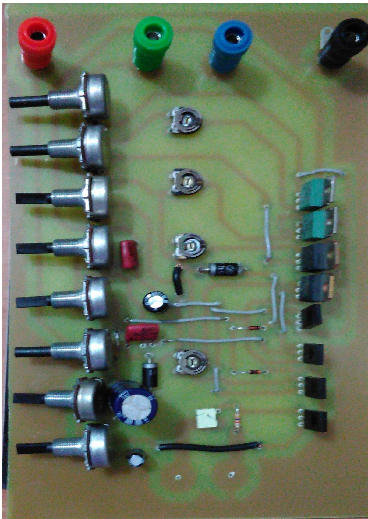
Figure 4.7 : implantation des composants et soudage.
