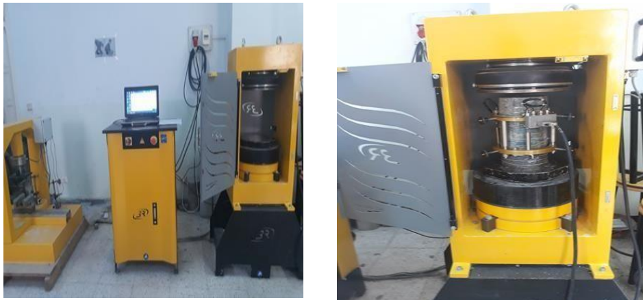
Figure IV.33 : La machine de l'essai de compression.
