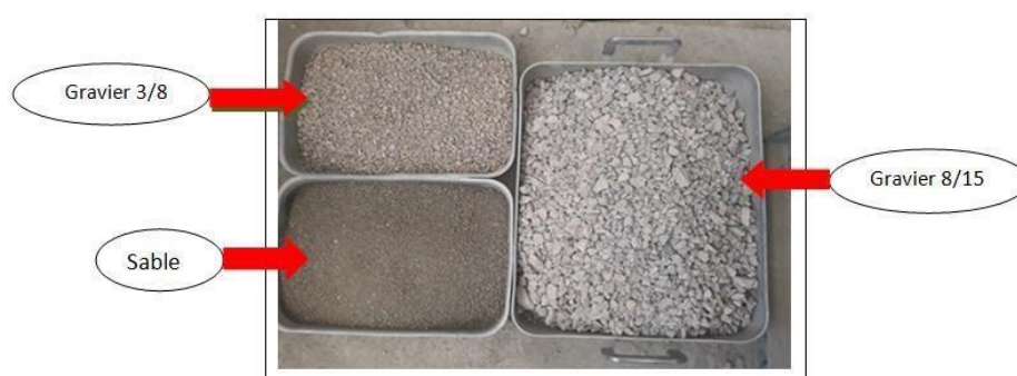
Figure IV. 1 : Les granulats utilisés.
