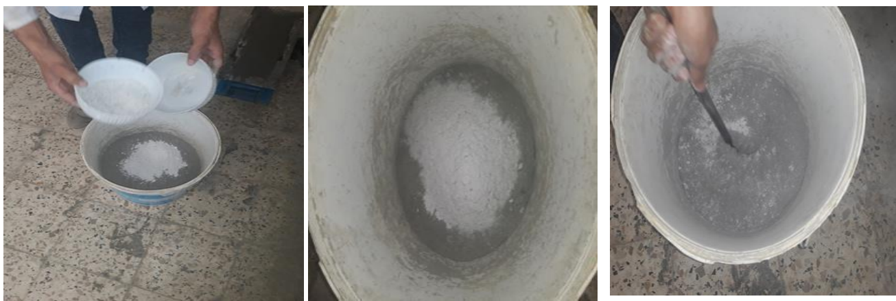
Figure IV.16 : Mélange du sable et la poudre de verre non colorée avec le ciment.
