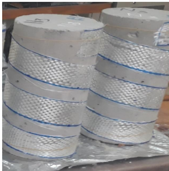
FigureIV.32 : Confinement hélicoïdal des éprouvettes avec le tissu de fibre de verre.
