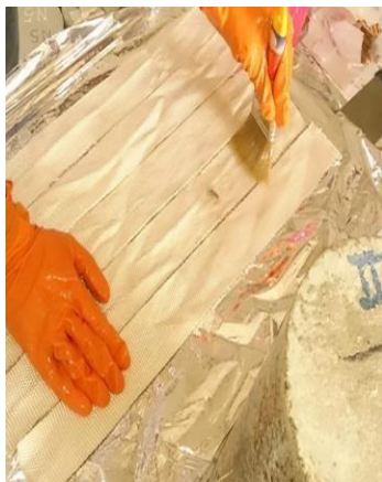
Figure IV.29: Confinement total des éprouvettes avec le tissu recyclé.
