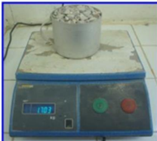
Figure IV.10 : Mesure de la masse volumique apparente des graviers.
