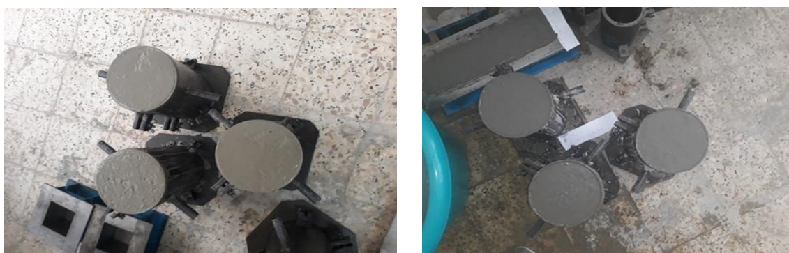
Figure IV.19 : Remplissage et séchage du béton pendant 24 h.
