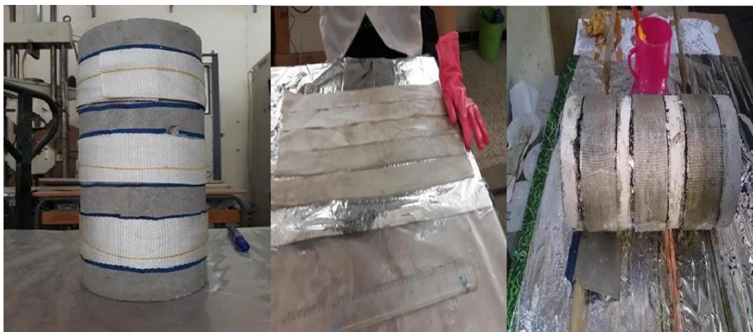
Figure IV.27 : Méthode de confinement partiel avec des bandes de tissu recyclé.
