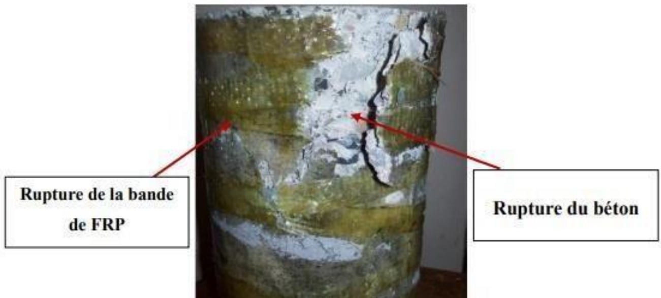
Figure III.2 : Mode de rupture des cylindres confinés avec le FRP. [4]
