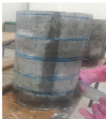
FigureIV.30 : Confinement total des éprouvettes avec la fibre de verre.
