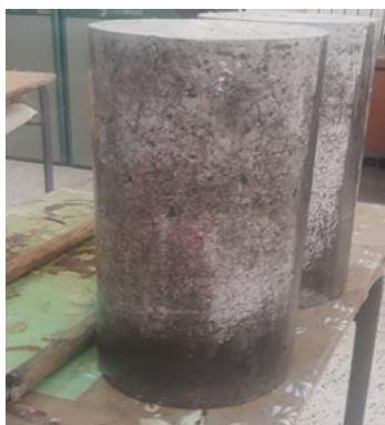
FigureIV.30 : Confinement total des éprouvettes avec la fibre de verre.
