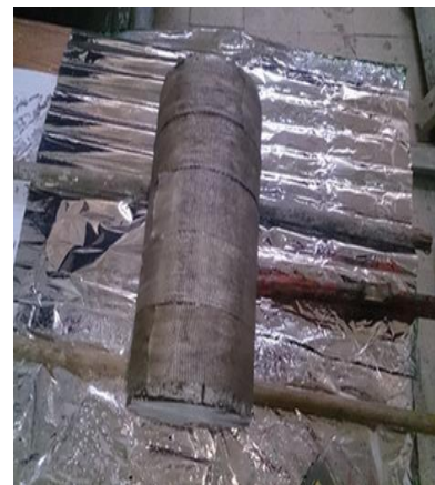
Figure IV.29: Confinement total des éprouvettes avec le tissu recyclé.
