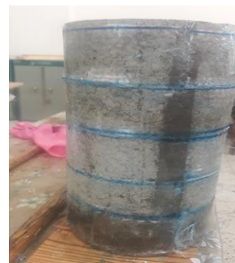
FigureIV.30 : Confinement total des éprouvettes avec la fibre de verre.
