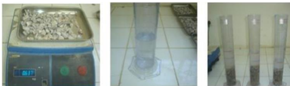
Figure IV.11 : Mesure de la masse volumique absolue des graviers.
