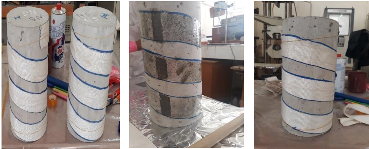
Figure IV.31 : Confinement hélicoïdal des éprouvettes avec le tissu recyclé.
