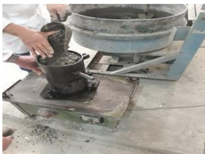
Figure IV.18 : Mise en place du béton dans le moule et vibration.
