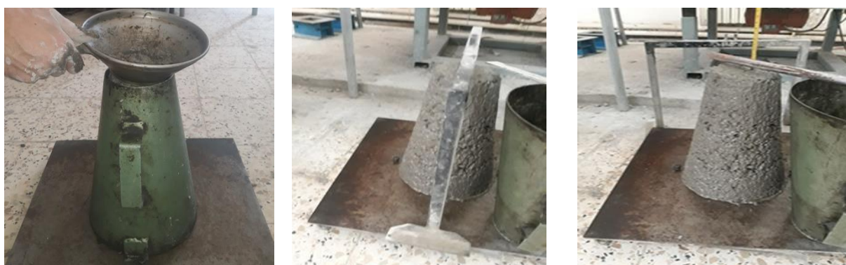
Figure IV.14 : Détermination d'affaissement du béton l'état frais.
