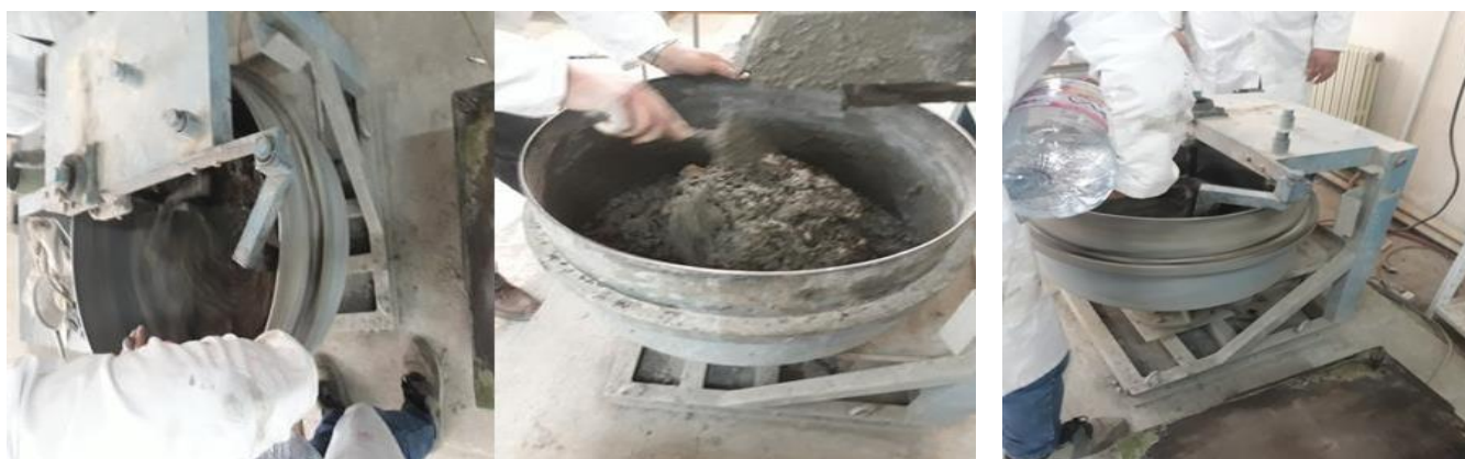
Figure IV.17 : Malaxage du béton.
