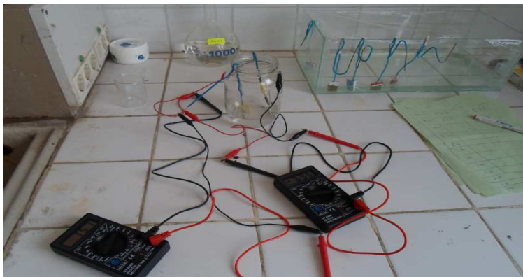
Figure III.11 : Le montage de la cellule électrochimique
