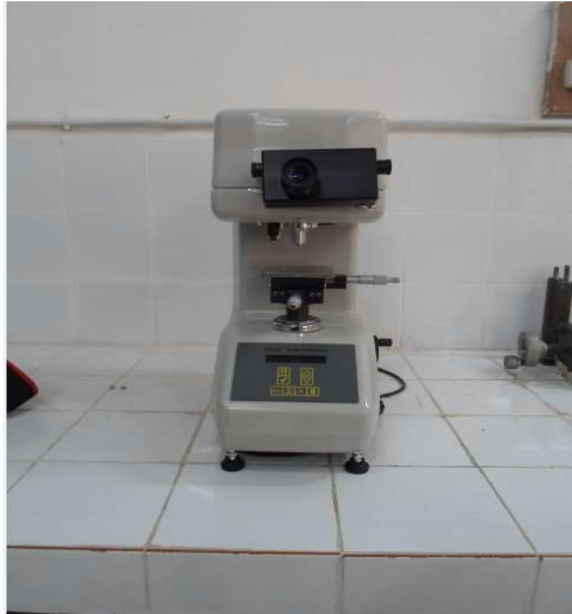
Figure III.7 : Schéma d'un MICRODUROMETRE de marque ZWICK
