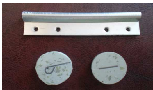
Figure III. 3 : La pièce et les échantillons prélevés
