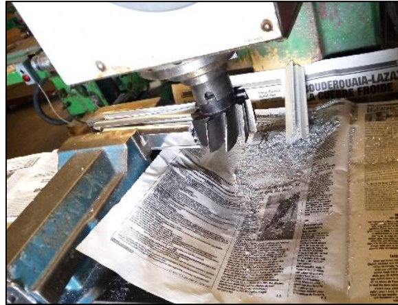
Figure IV.5. La fraiseuse utilisée pour la fabrication de coupeaux d'aluminium
