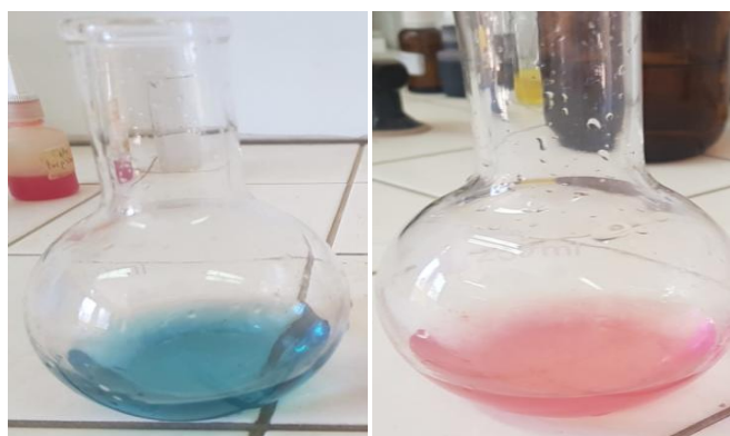
Figure 08 : virage de l'indicateur coloré lors du dosage de titre alcalimétrique complet (TAC) (originale, 2019).
