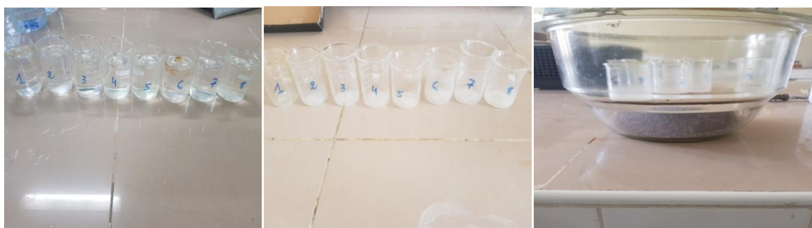
Figure 20 : Etapes de détermination des résidus secs (originale, 2019)
