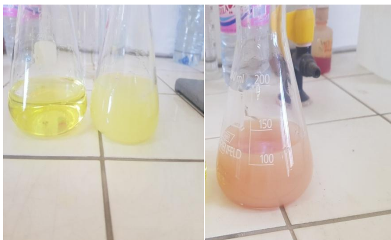
Figure13 : changement de la coloration de l'échantillon analysé lors du dosage des chlorures (originale, 2019).
