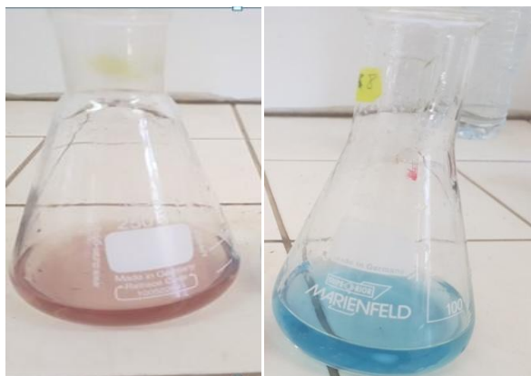
Figure 09: virage de l'indicateur coloré lors du dosage de la dureté.
