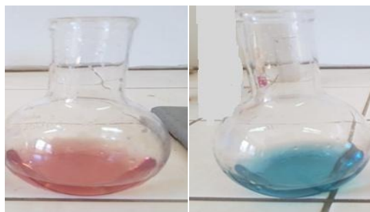
Figure 10 : virage de l'indicateur coloré lors du dosage de la dureté calcique par une solution d'EDTA (originale, 2019).
