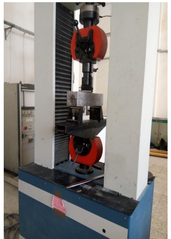
Fig. II. 22. Soumission des éprouvettes au chargement par flexion trois points
