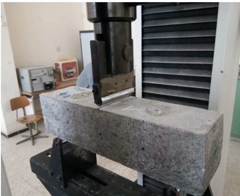
Fig. II. 22. Soumission des éprouvettes au chargement par flexion trois points
