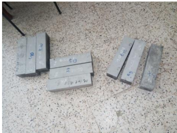
Fig. II. 17. Les éprouvettes soumises a l'essai de flexion trois points
