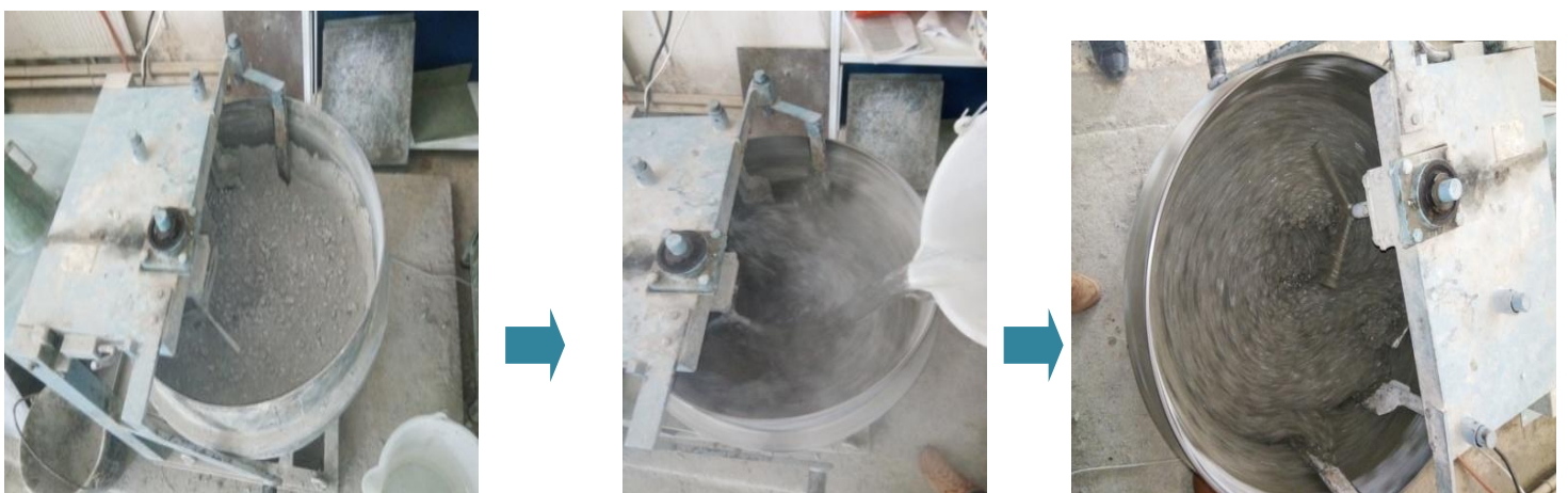
Fig. II. 12. : Malaxage des matériaux à sec et avec l'ajout de l'eau
