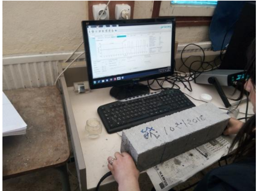
Fig. II. 23. Mesure des vitesses de propagation en différents points
