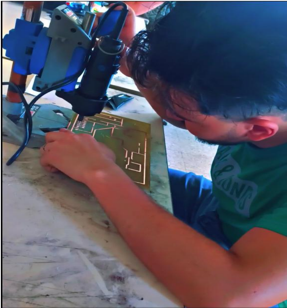
Figure III.18 : Perçage de la carte électronique.
