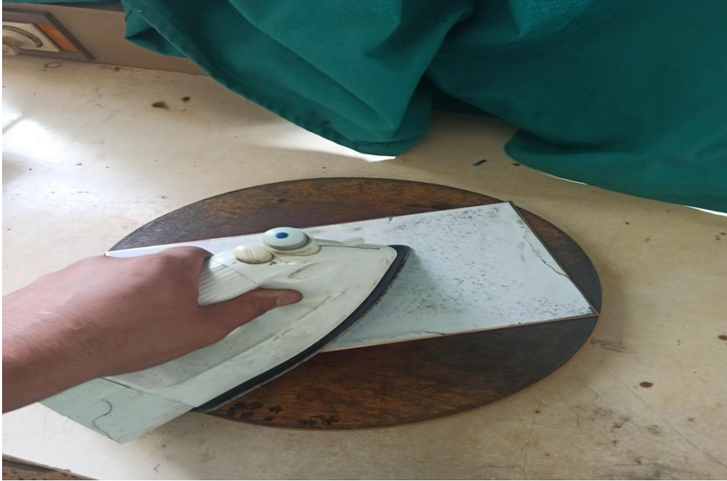
Figure III.16 : Fer à repasser sur le papier photo
