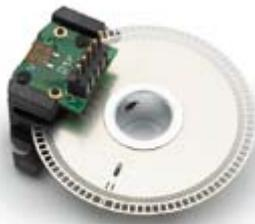
**Figure (II.6) :** Photo d'un codeur incrémental
