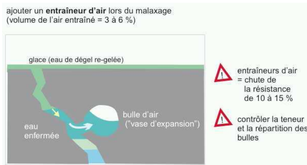
Figure II.8 : Ajout d'entraîneur d'air lors du malaxage.
