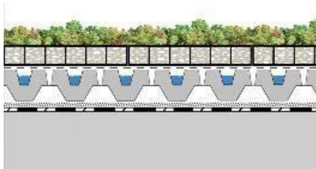
Figure 110 : toiture végétalisée planché collaborant
