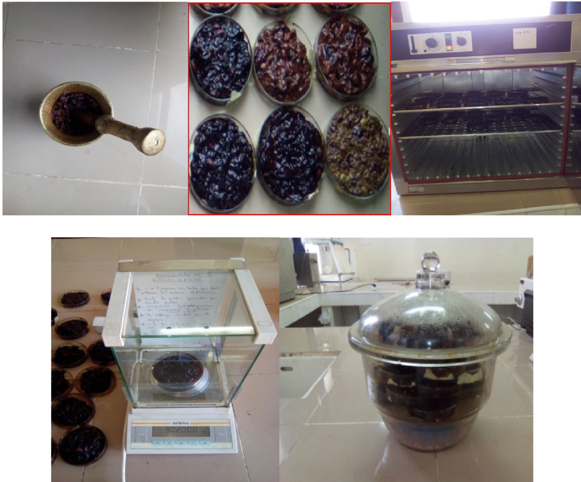
Figure 08 : Différentes étapes de détermination du taux d'humidité des olives (Laboratoire commun I, 2018)
