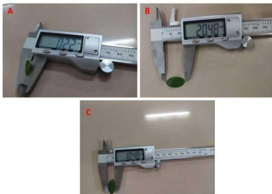
Figure 17. Mesure de l'épaisseur, de la longueur et de la largeur des feuilles à l'aide d'un pied à coulisse électronique (précision au millimètre).
