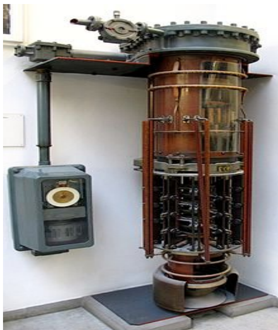
Figure III.1 : Changeur de prises selon le principe de Jansen avec son module de contrôle, construit en 1952 et exposé au Deutsches Museum
