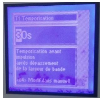
Figure IV.16 : Réglage de la temporisation
