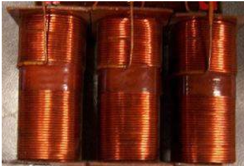
Figure I.1 : Enroulement triphasé d'un transformateur
