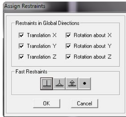
Fig 5.13 : Encastrement des appuis.
