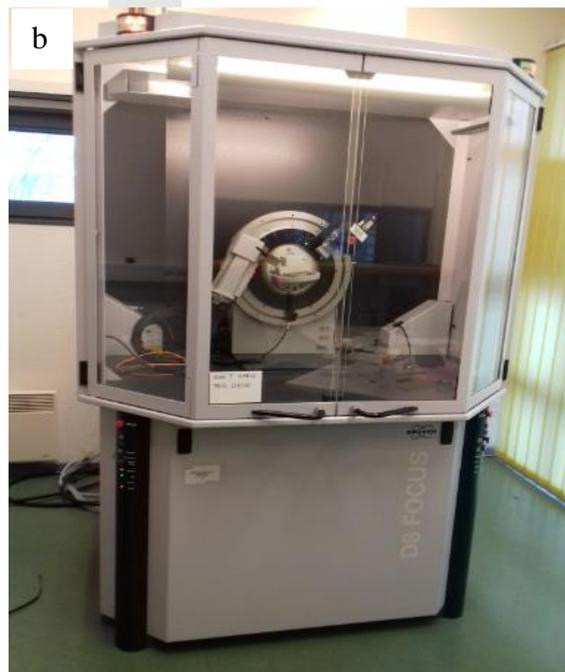
Fig II.6 Schéma de diffraction des rayons X (DRX) en configuration  $\theta/2\theta$  et la photographie du dispositif utilisé
