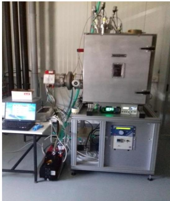
Fig II.4 Représentation de la machine de dépôt utilisée pour les films  $\text{SnO}_2$  et  $\text{ZnO}$
