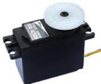
**Fig.2.3 :** Servomoteur
