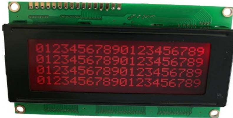
**Fig.2.5** : Afficheur LCD 20x4
