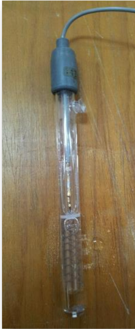
Figure II.4 : Electrode de référence
