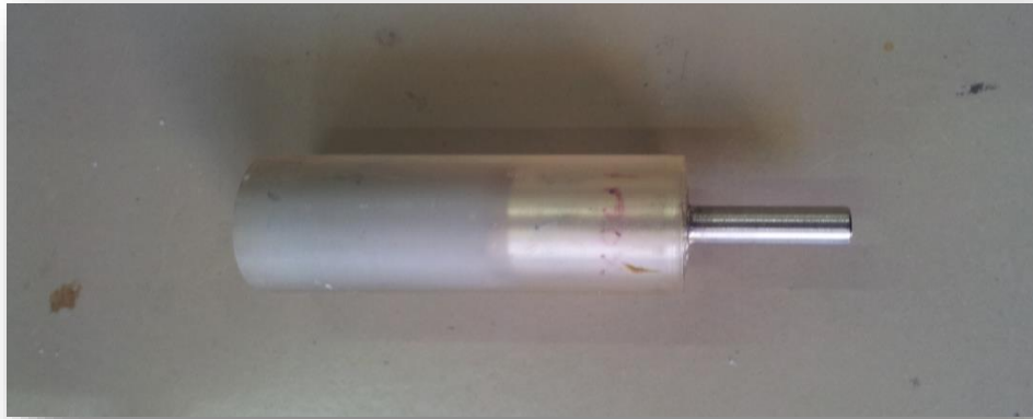
Figure II.3 : Electrode de travail
