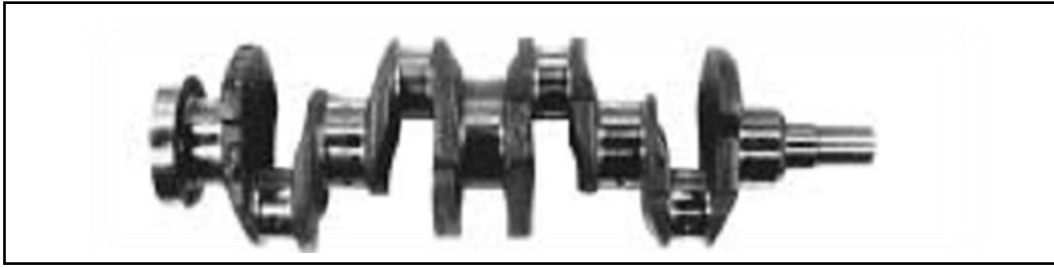
Figure I. 32 : Vilebrequin en ADI pour un moteur Ford turbocompressé. L'ADI est capable de satisfaire aux impératifs de fatigue à coût beaucoup moins élevé que l'acier forgé. [5]
