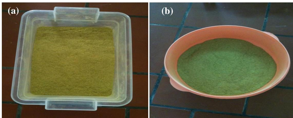
Figure III.1: La charge de Diss ; (a) non traitée, (b) traitée avec la soude 5%.
