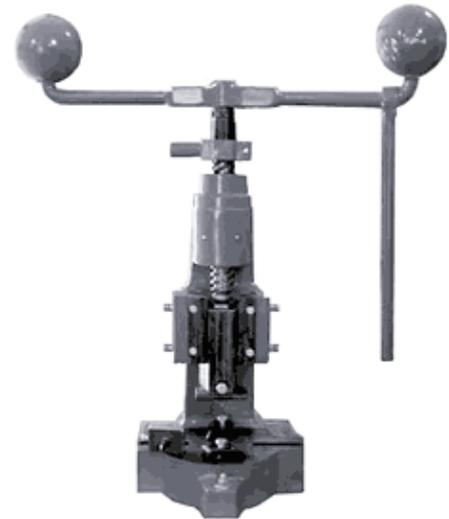
Figure III.2: presse à vis avec volant d'inertie
