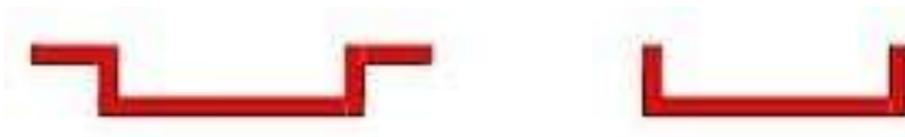
Figure I.5 : Le détourage de la pièce emboutie.
