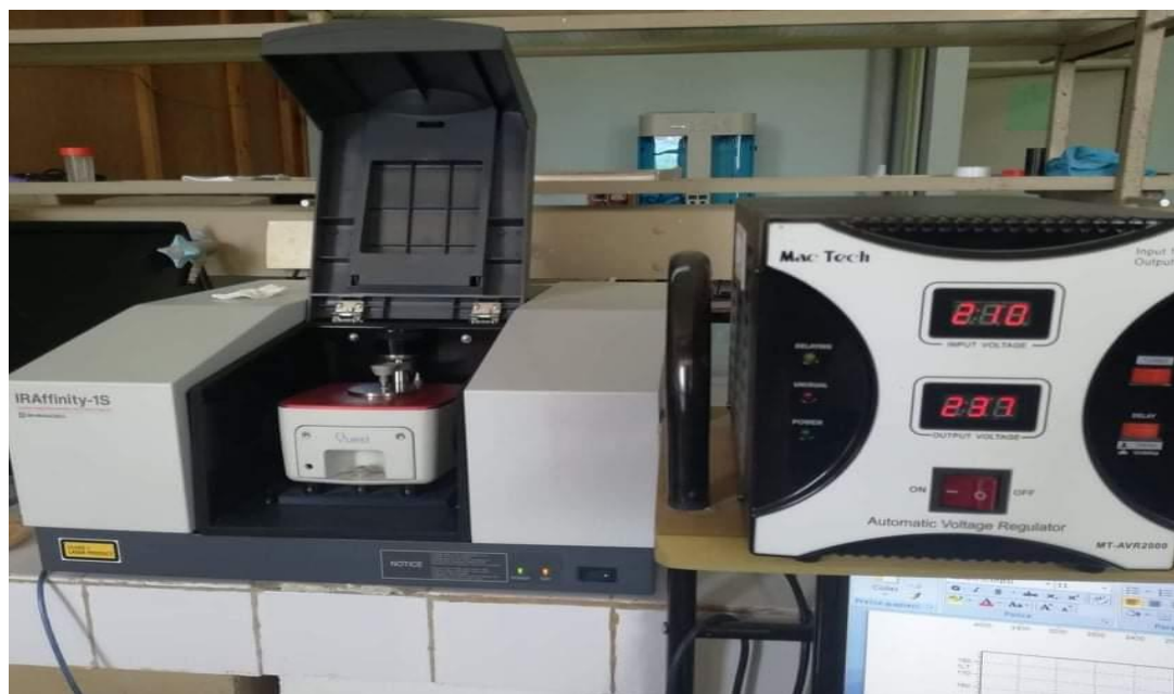
Figure II-3. Spectrophotomètre de type « IRAffinity-1S ».
