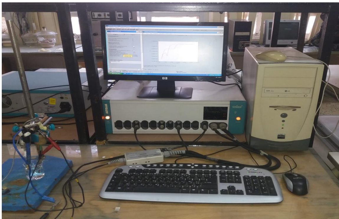
Figure II-8. Dispositif de l'étude électrochimique (AUTOLAB).
