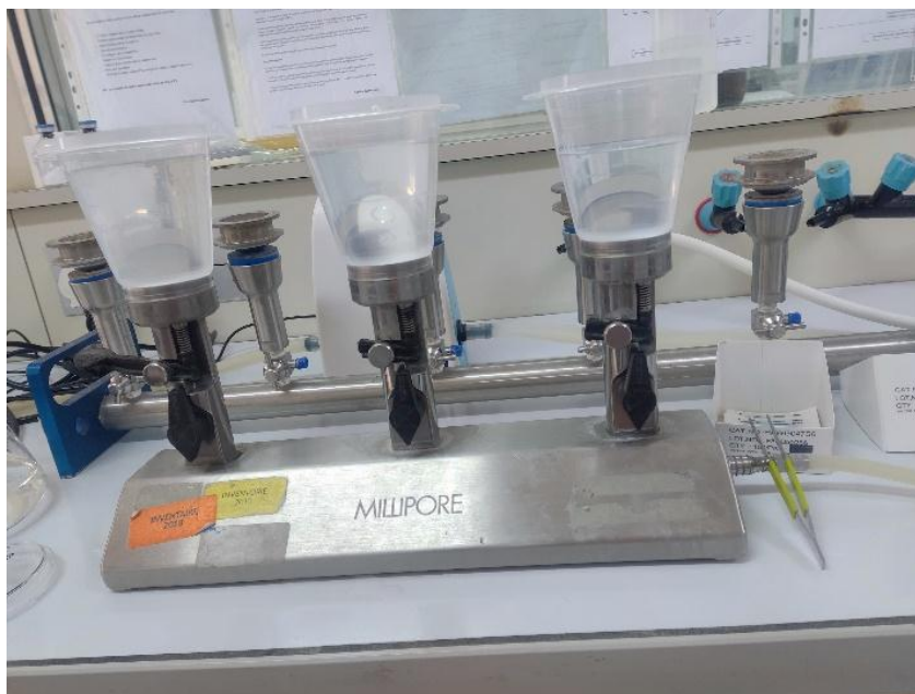
Figure 12 : Une rampe de filtration d'eau Millipore™ (originale)
