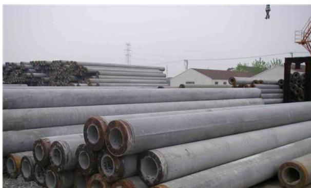
**Figure IV.8 Pieux en béton précontraint.**
