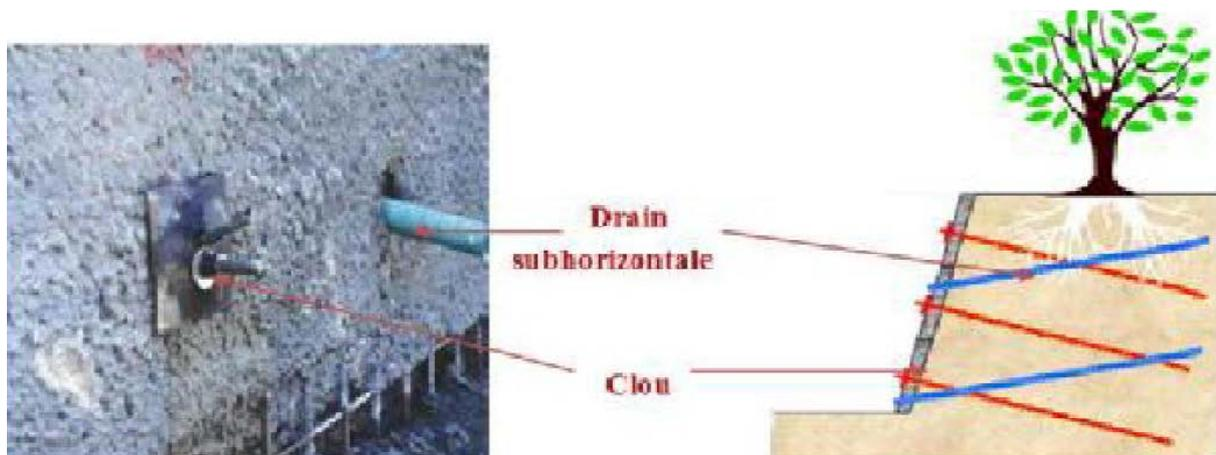
**Figure III.7 Drains subhorizontaux.**
