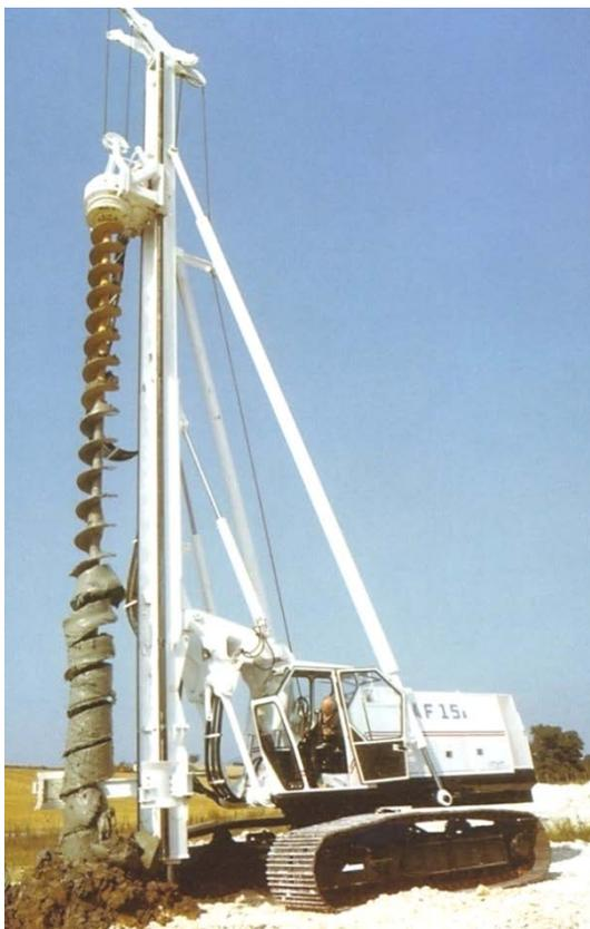
**Photo III.17.** Engin de forage à la tarière creuse.
