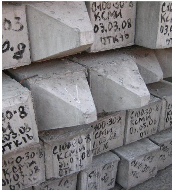
Photo IV.2 Pieux battus préfabriqués en Béton armé.
