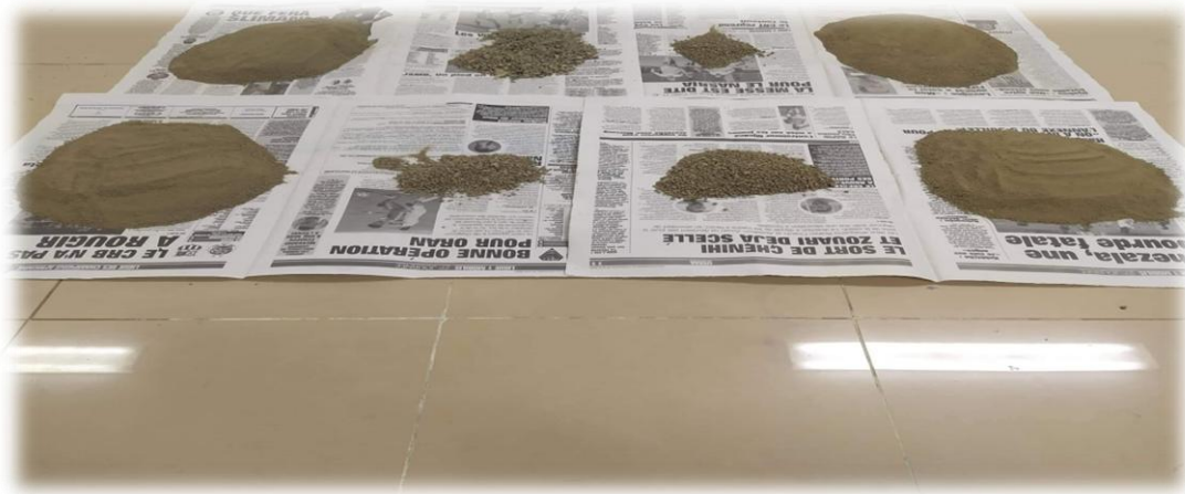
Figure 15 : Tamisage des échantillons entre 5 et 3mm
