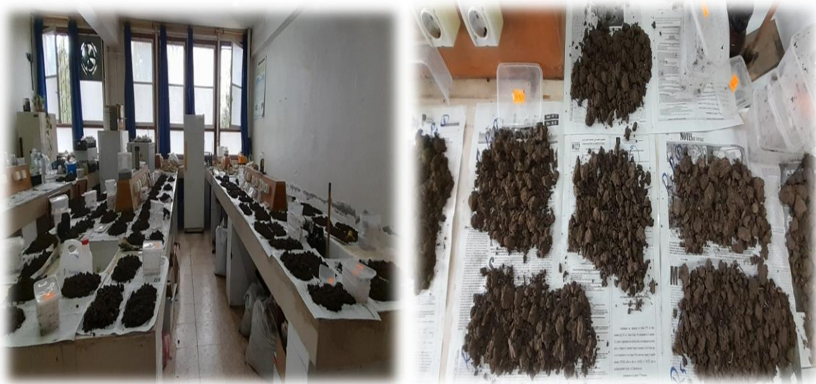
Figure 14 : Séchage des échantillons à l'air libre au laboratoire.
