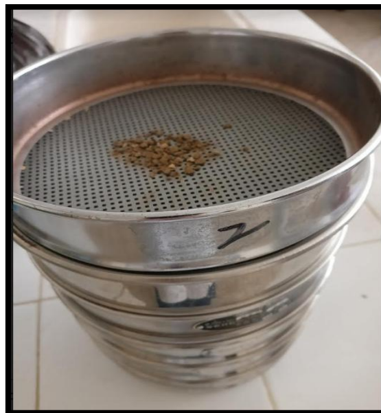
Figure 19 : Colonne de tamis ( 2 ;1 ;0,5 ;0,2 ;0,1 ;0,05 mm)(Originale,2024)
