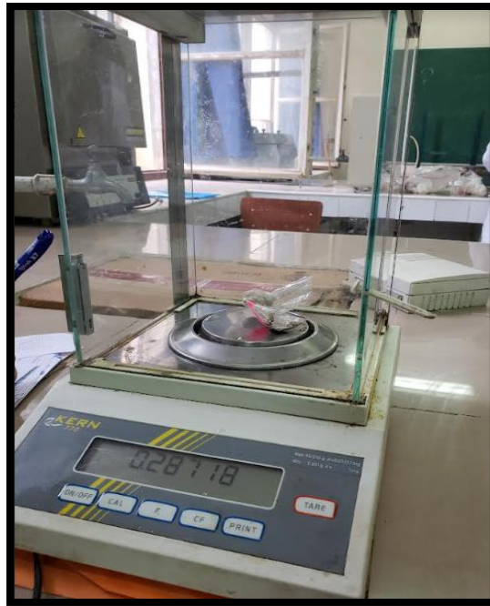
Figure 20 : Poids des fractions obtenues après le tamisage(Originale,2024)
