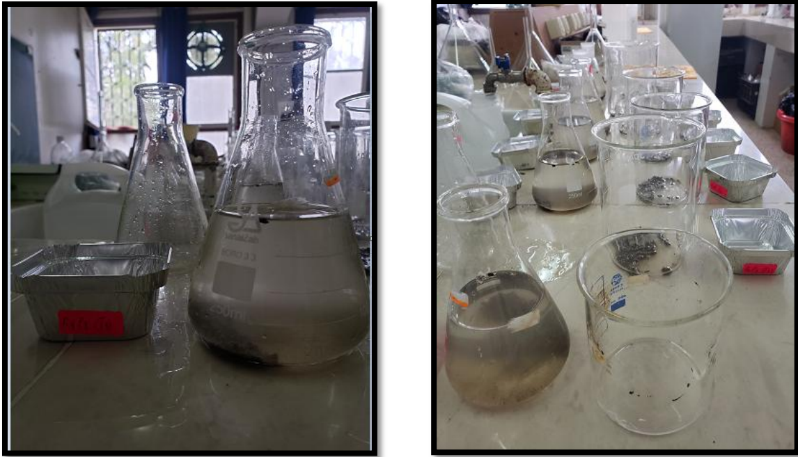
Figure 18 : Désagrégation mécanique par agitation après ré-humectation(Originale,2024)
