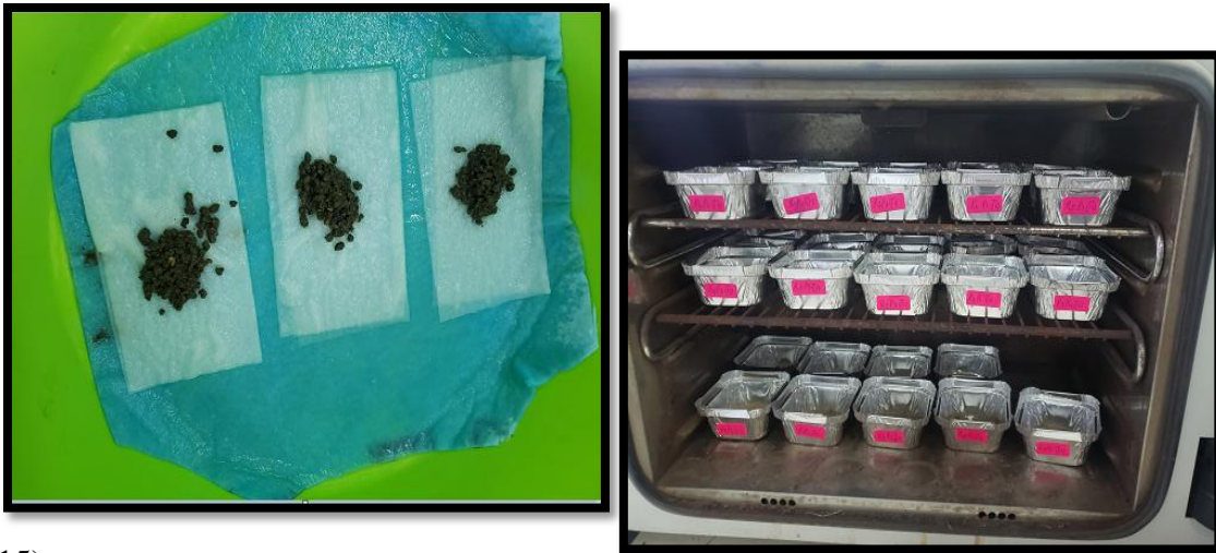
Figure 17: Test d'humectation par capillarité (Originale, 2024)
