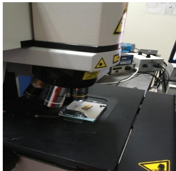
Figure 28 : Analyse de l'électrode d'Or par spectromètre. (RAMAN)
