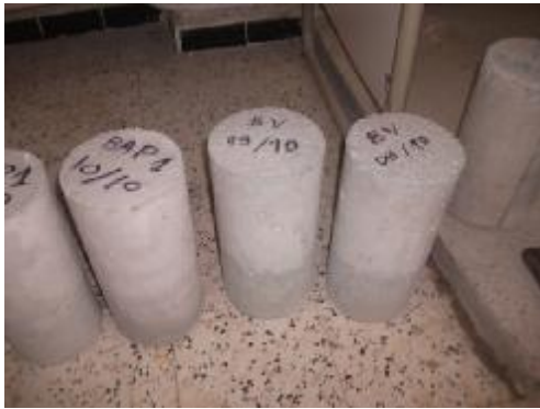
Fig II.12 : Epreuves d'essai de compression
