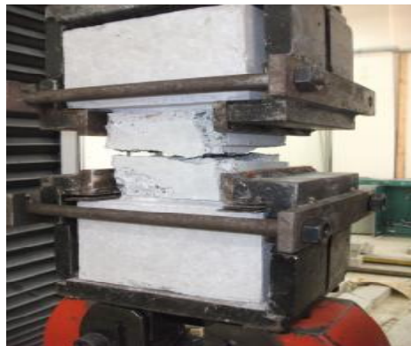
Figure II.23 : Rupture de l'éprouvette
