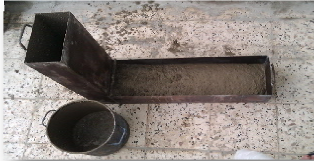
Figure II.10 : Essai de la boîte en L
