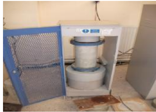
Fig II.13: Presse utilisée pour la compression
