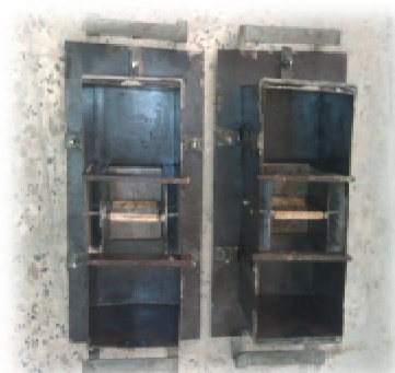
Figure II.21 : Forme et dimensions de l'éprouvette de traction directe
