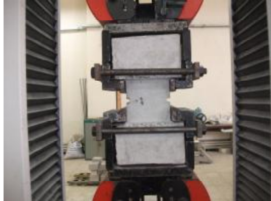
Figure II.22 : Eprouvette soumise à la traction directe
