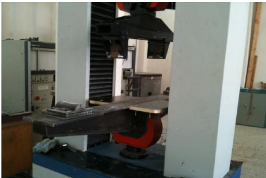
Figure II.35 : Dispositif d'essai de flexion à quatre points
