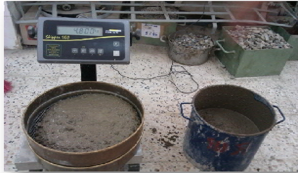
Figure II.11 : Essai de stabilité au tamis
