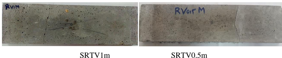
Figure III.23: Modes de rupture des plaques renforcées par des tissus de verre avec différentes dimensions des mailles.
