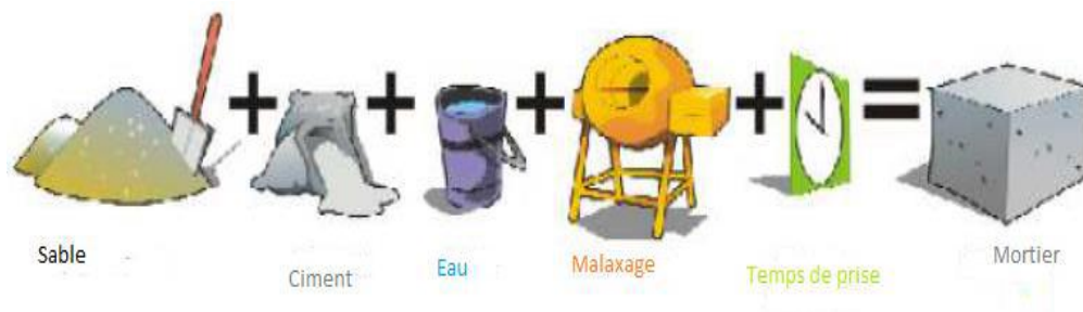
Figure I.2-2 : Composition d'un mortier.
