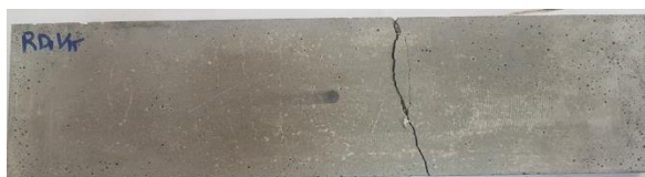
85%SRSDTV (rupture par flexion)
