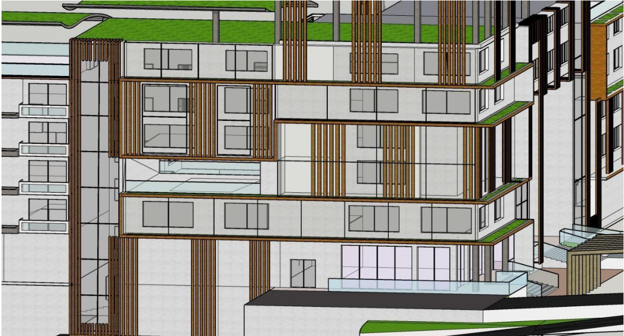
Figure 119: les brises soleil sur la façade Sud La source : auteures
