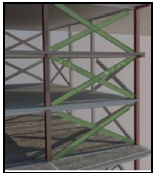
Figure170:Contreventement dans l'entité loisirs
