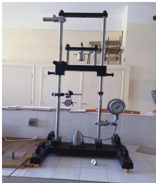
Figure IV-1 : Appareil de flambement (WP 120)
