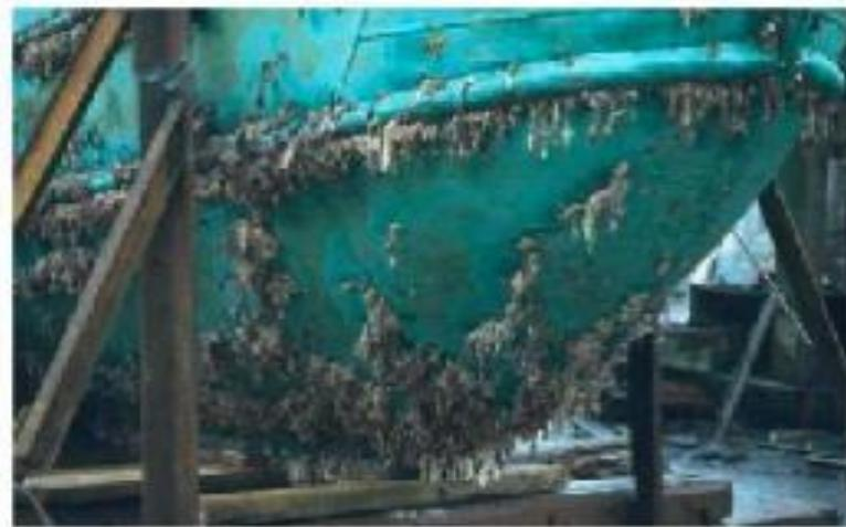
**Figure 6 :** Le *biofouling* sur un bateau (CANDRIES *et al.*, 2000).
