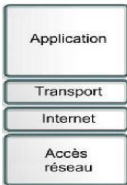
**Fig.I.7 : Les quatre couches de TCP/IP.**
