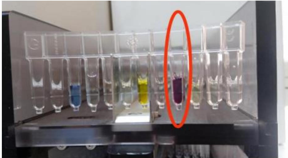
Figure 17 : Cuvette Segment HORIBA ABX Pentra C400 (couleur du calcium violette intense) (Photo personnelle).
