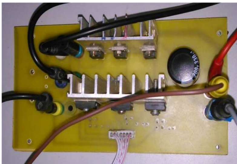
Figure III.5. La carte du hacheur élévateur entrelace a trois niveaux
