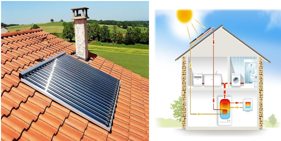
Figure I.6: schéma de fonctionnement de l'énergie thermique
