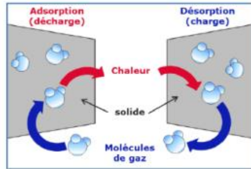
Figure II.14 : Principe de stockage de l'énergie par adsorption/désorption [26]
