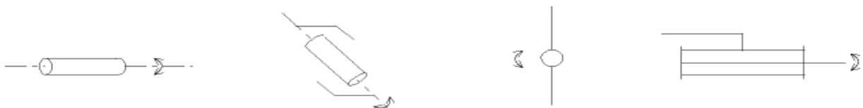
Figure [I.2] : Symbole de l'articulation rotoïde .
