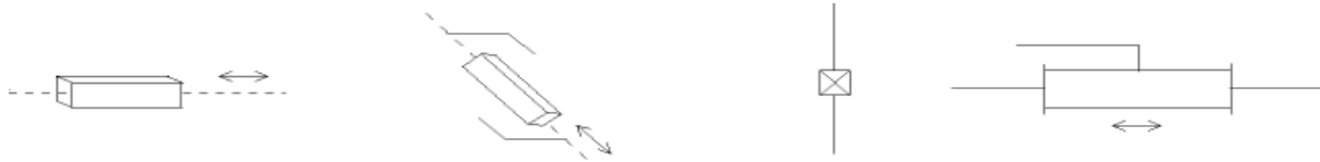
Figure [I.3]: Symbole de l'articulation prismatique.
