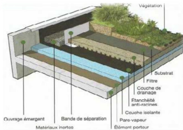
Figure 13 : Coupe schématique sur la toiture végétalisée
