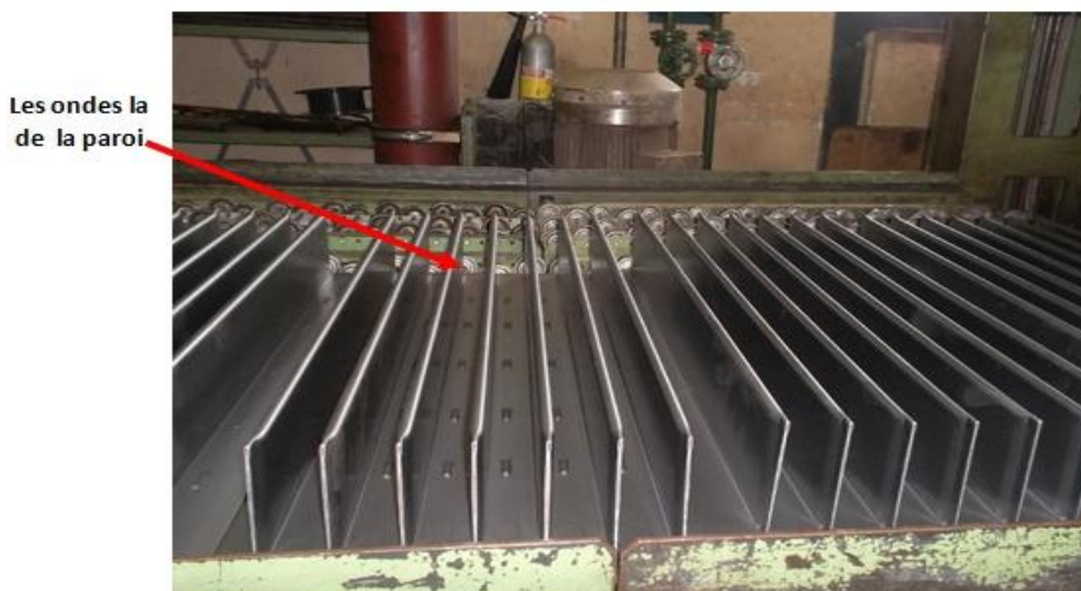
Figure I.3. Les ondes de la paroi du transformateur [1].
