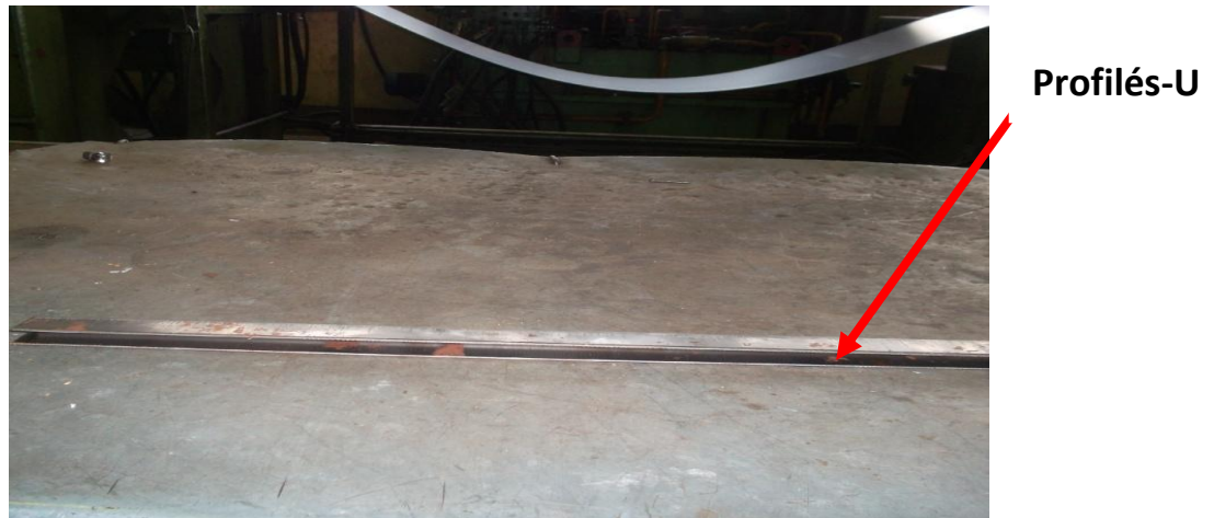
Figure I.4. Les profilés U fabriqués par la presse [1].
