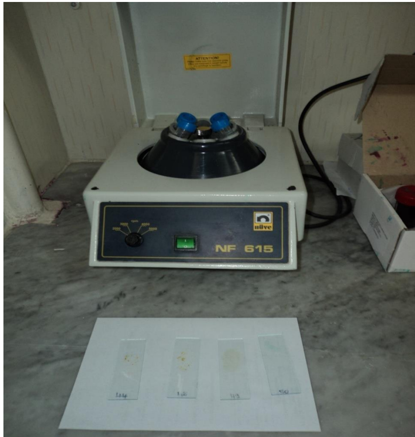
Figure 11 : Centrifugation pendant la technique de Ritchie (originale)
