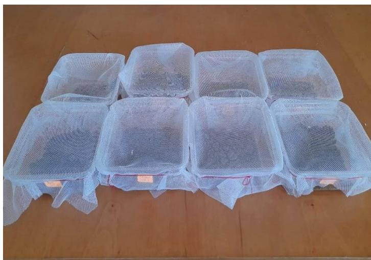
**Fig. 11 :** Protocole du test de toxicité sur les vers de terre.
