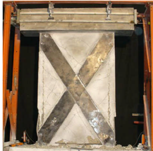
Figure III.17 : Fissuration du spécimen 2.
