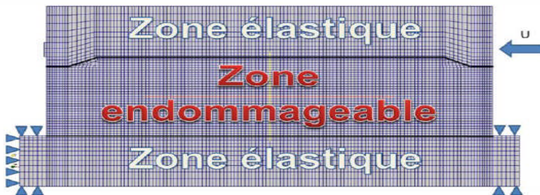
Figure II.30 : discrétisation par éléments finis du voile .
