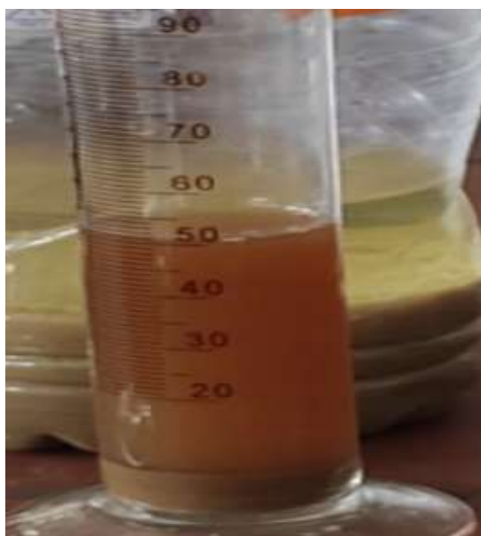
Figure C. II.2. Margine traitée filtrée par l'éponge et les grignons d'olives.
