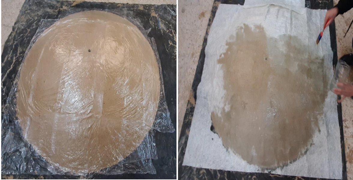
Figure V.7 : Pose de la feuille de cellophane, la fibre de verre et la résine
