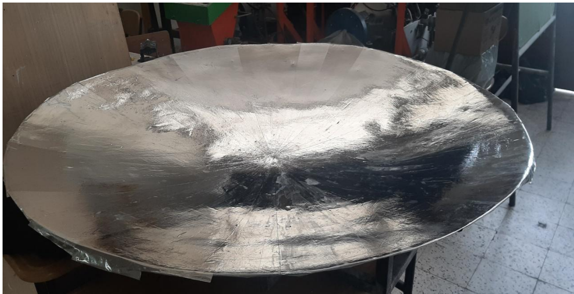
Figure V.12 : La surface finale de concentrateur
